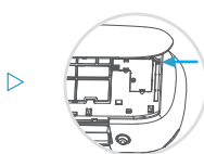
两手捏住两端铰链轻轻 向外推，同时向上抬起
