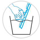
将导风板清洗干净
